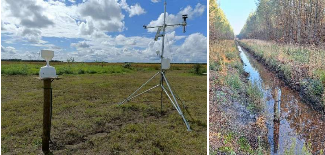
Station météo installée en Juillet 2022 à Hourtin (gauche) et exemple d'ouvrage de suivi piézométrique automatisé en drain à Sescousse (droite).
